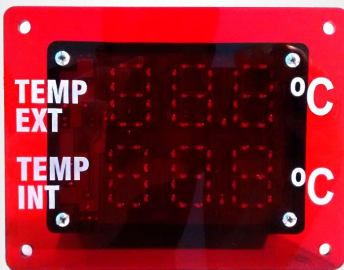
El MTemp es un equipo pensado especialmente para la industria automotriz, midiendo temperatura ambiente en el interior del vehículo como así también en el exterior del mismo. La lectura de las temperaturas se visualizan en forma simultánea en dígitos de leds de alto brillo color rojo, alto contraste y de gran formato, permitiendo observar la lectura desde una gran distancia.
